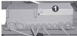
Batterie der Steuereinheit
